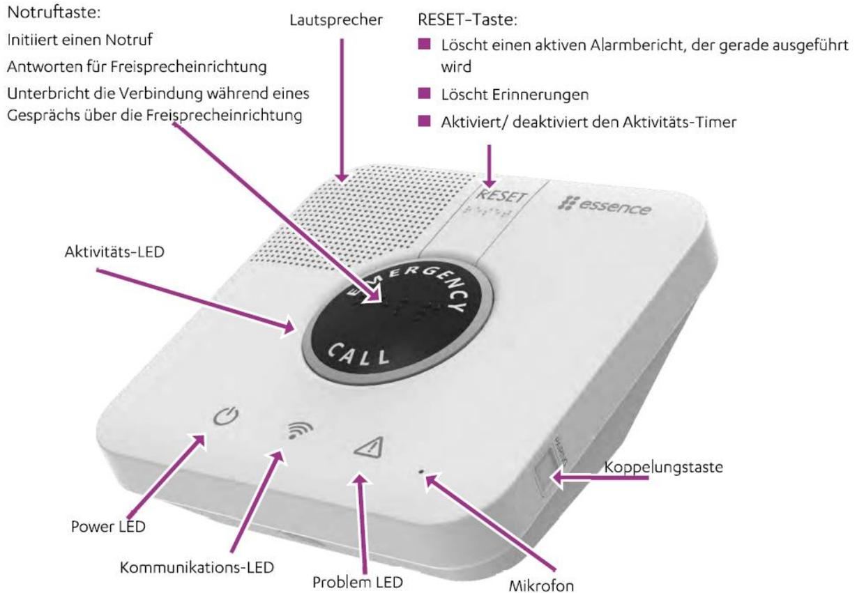
Die Basisstation wird über ein externes Netzteil (im Lieferumfang enthalten) betrieben. Das Netzteil ist für eine Eingangsspannung von 90 - 240VAC, 50/60Hz ausgelegt.
